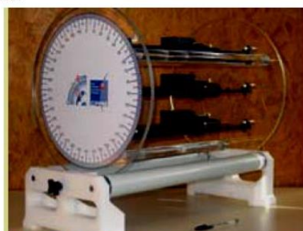
Doc. 3 Un exemple de détecteur de muons : le cosmodétecteur, réalisé par le Centre de physique des particules de Marseille (CPPM) dans le cadre de l'opération Cosmos à l'École, menée conjointement par Sciences à l'École et l'IN2P3.
