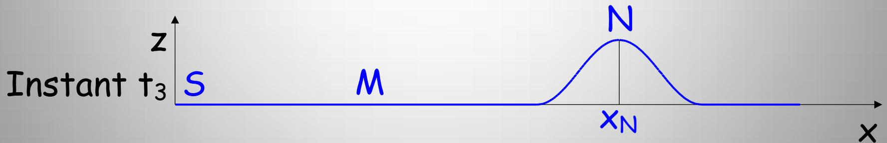
La déformation créée en S se propage de proche en proche dans le milieu matériel avec la célérité  $V$ .
